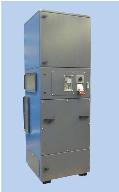
Komplet og pladsbesparende "Plug & Play" trykluftrenset filteranlæg med integreret ventilator, der anvendes til filtrering af luft fra processer, der danner begrænsede støvmængder (svejsning, skæring, slibning o.l.). Kan placeres i produktionslokalet og filtrere udsugning fra op til 7 samtidige svejsesteder.
